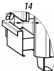
Joonis 8. Tuhakoguja asend süütamisel või halgude ladumisel ahju (intensiivne režiim)
